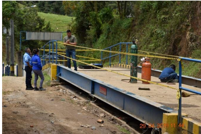
Ilustración 75 Calibración de báscula camionera
